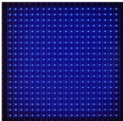
Image 1 : microLED FlexiNOVA 6V de 15 \times 30 \mu\text{m}^2 assemblées sur un écran au pas de 400 \mu\text{m}
